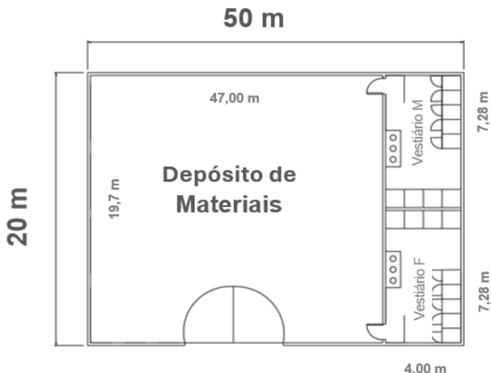
Figura 34-4: Layout do depósito de armazenamento de resíduos
